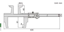
**DIGITAL DRUM BRAKE CALIPERS**
